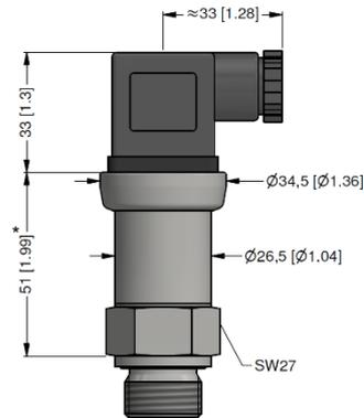
\* für Nenndruckbereiche  $p_N > 60$  bar erhöht sich die Länge der Geräte um 9 mm;
