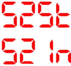
Über das Menü „Schaltausgangsinvertierung“ kann die Schaltlogik des Schaltausgangs 2 umgekehrt werden. Durch gleichzeitiges Drücken beider Tasten gelangt man in den Einstellmodus. Zur Umschaltung zwischen Standard Signal (S2St) und invertierten Signal (S2In) betätigt man entweder die linke oder die rechte Taste. Ist die richtige Schaltlogik eingestellt, bestätigt man die Eingabe durch gleichzeitiges Drücken beider Tasten.
