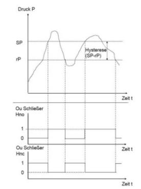
Abb. 4 Schalt- und Rückschaltverhalten bei Hysterese im Druck-Zeit-Diagramm
