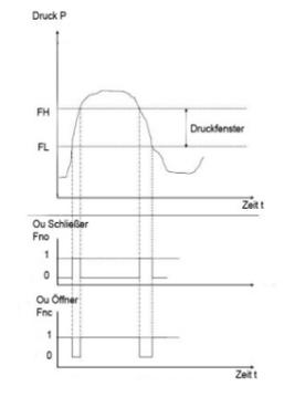
Abb. 6 Schalt- und Rückschaltverhalten bei Fensterfunktion im Druck-Zeit-Diagramm
