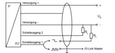
**3-Leiter-System (IO-Link / SIO mit Analogausgang)**
