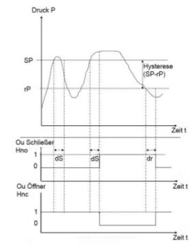
Abb. 5 Schalt- und Rückschaltverzögerung bei Hysterese im Druck-Zeit-Diagramm
