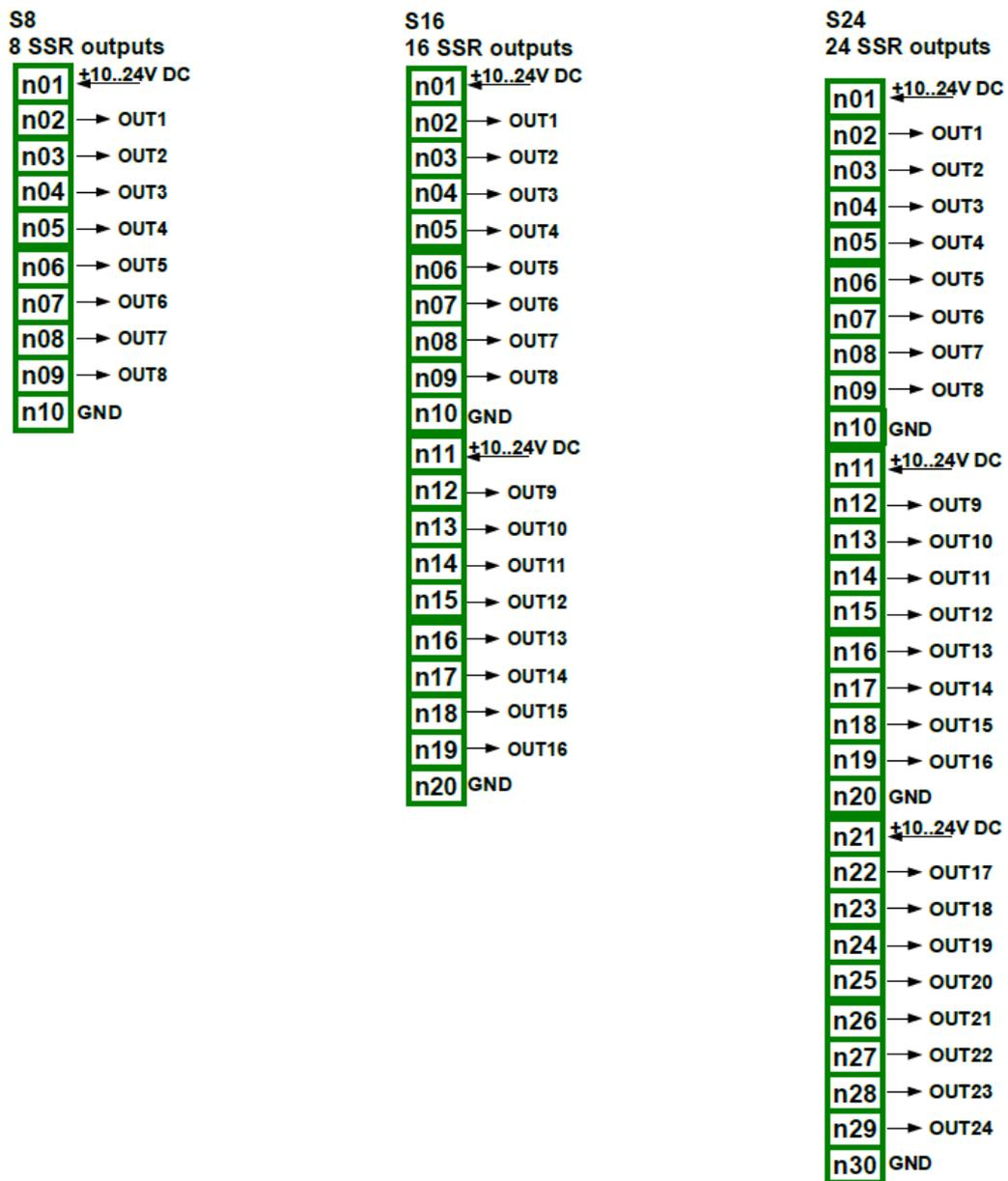
Abb. 4.18 SSR-Ausgangsmodule
