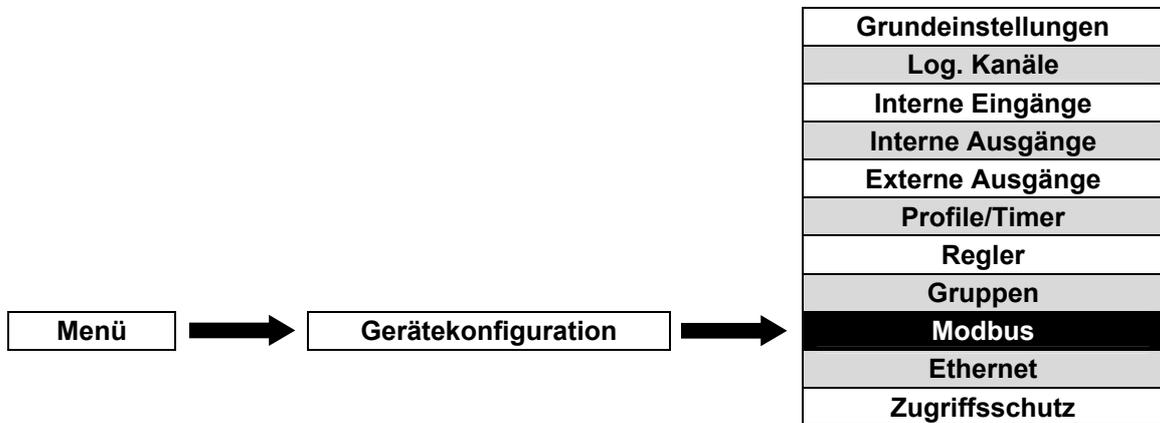
Die Grundversion des Geräts verfügt über eine integrierte Kommunikations-Schnittstelle RS-485(Modbus RTU). Durch die Installation eines weiteren Kommunikationsmoduls(ACM) kann diese Anzahl erweitert werden. Das Modul bietet zwei weitere serielle Schnittstellen(1x RS-485, 1x RS-485/RS-232) sowie einen Ethernet-Anschluss. Hiermit können Multi-Modbus-Netzwerke erstellt werden. Bisher sind ausschließlich die Protokolle ModbusRTU(Master/Slave) und ModbusTCP(Slave) verfügbar.
