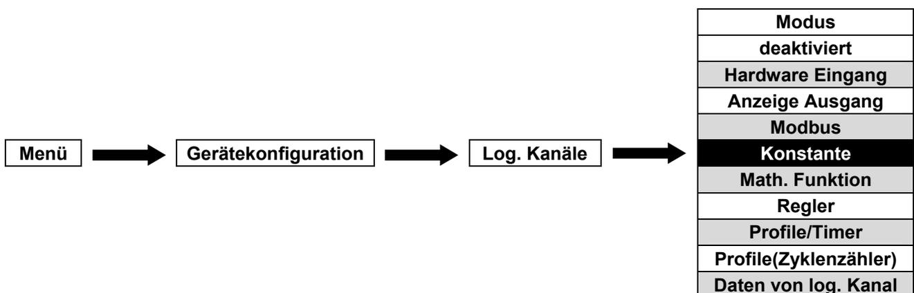
Dieser Modus ermöglicht es, einen konstanten Wert in einem log. Kanal zu definieren und für die Anzeige oder weitere Verarbeitung zu nutzen. Es sind folgende Parameter verfügbar:
