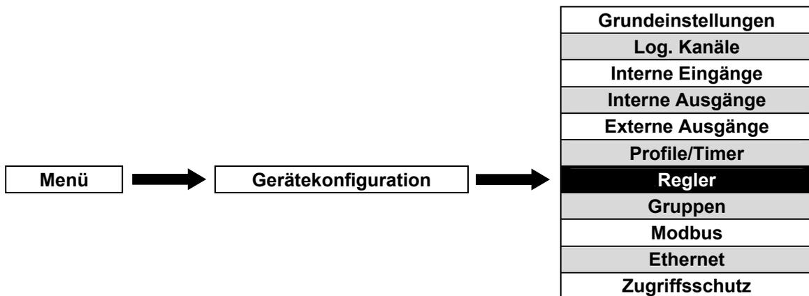
Obwohl die meisten Steuerprozesse mit einer einfachen Zweipunktregelung realisiert werden können, ist gelegentlich eine differenzierte Steuerung von Stellgliedern erforderlich. Das Gerät verfügt über 8 integrierte PID-Regelprofile, die von jedem logischen Kanal im Modus Regler verwendet werden können. Prinzip dieser Regler ist es, die Abweichung von Prozessparametern zu Sollwerten zu ermitteln und diese durch die Veränderung von Ausgangsgrößen zu minimieren.
