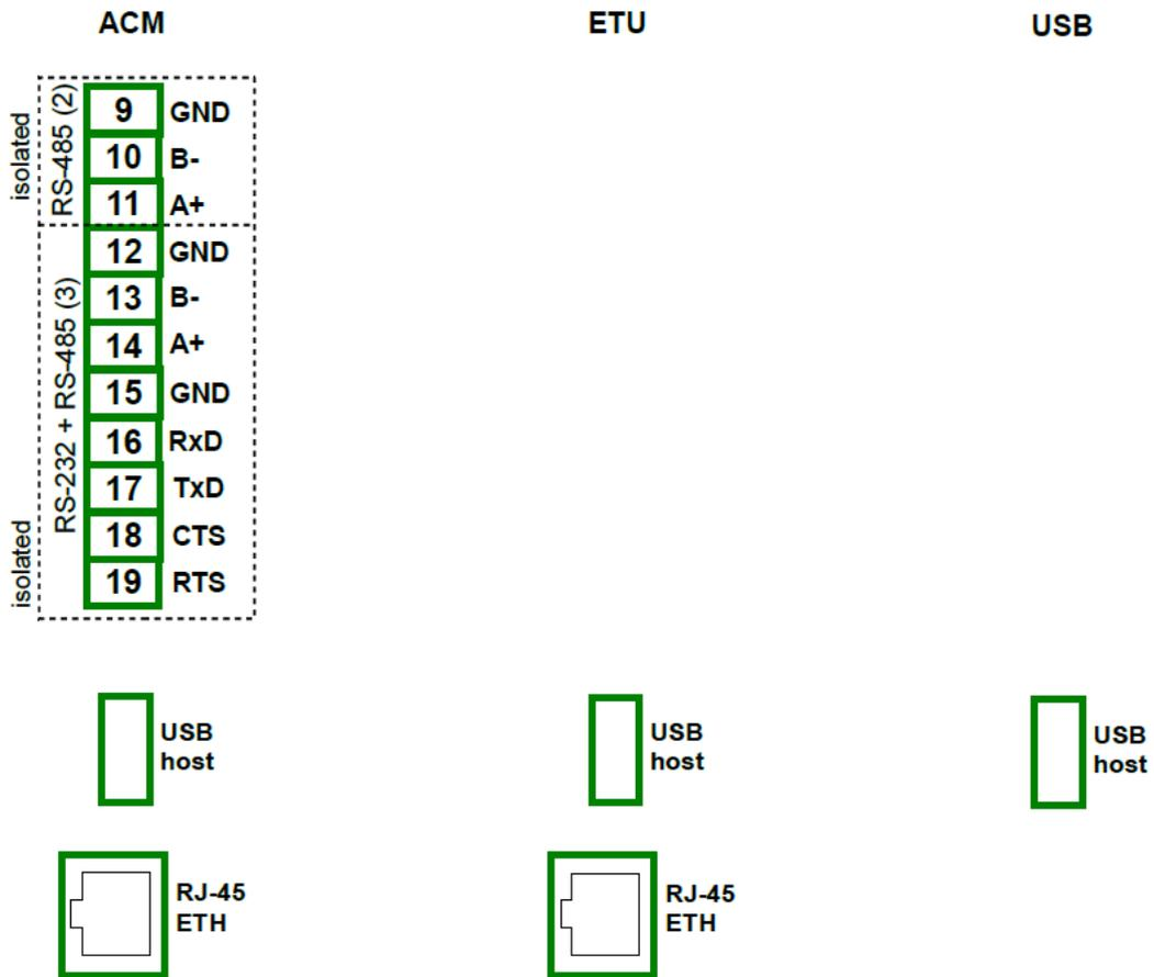
Abb. 4.21 Kommunikationsmodule
