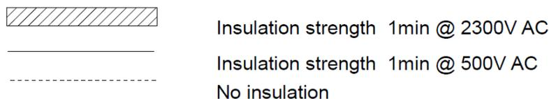
*Abb. 4.1. Schematische Abbildung der Isolationsfestigkeit zwischen den einzelnen Schaltkreisen des Geräts*
