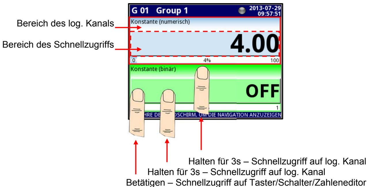
Abb. 7.49 log. Kanäle im Modus Konstante mit aktiviertem Schnellzugriff
