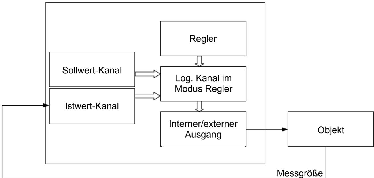
Abb. 7.108 Blockschaltbild eines Regelkreises mit dem Gerät
