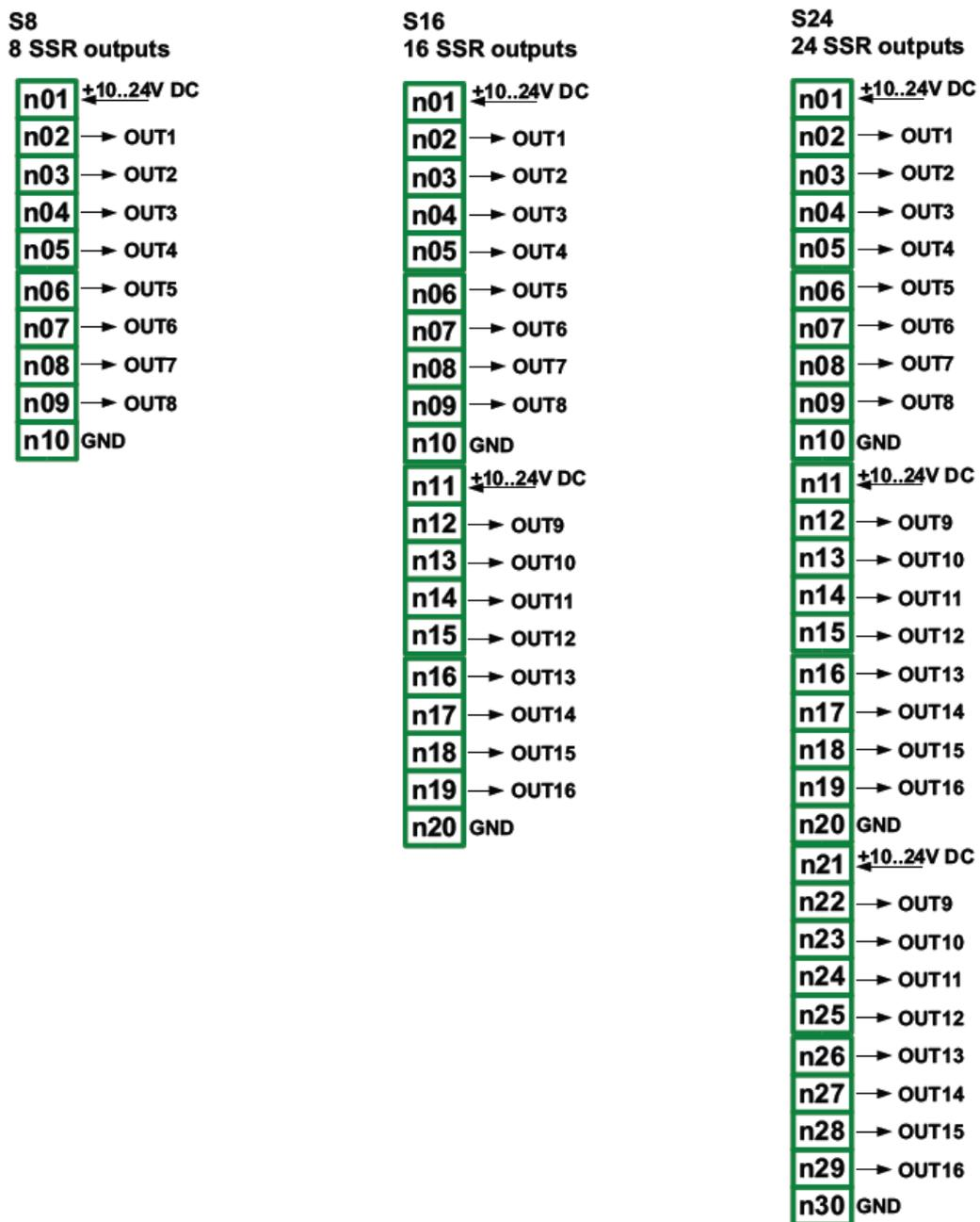
Abb. 8.20 SSR-Ausgangsmodule
