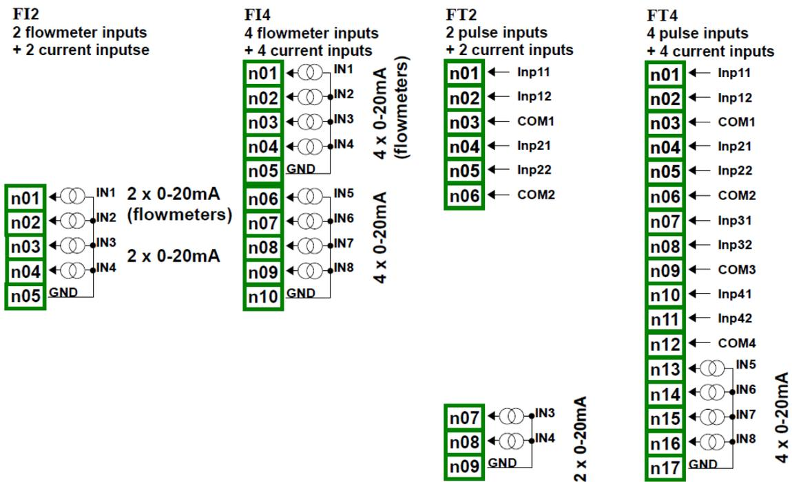
Abb. 8.9 Flowmeter-Eingangsmodule
