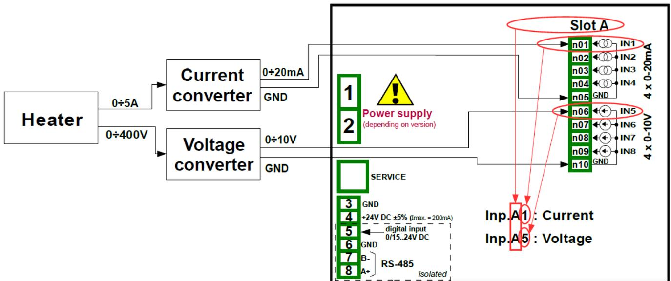
Abb. 7.57 Anschluss von Konvertern und Heizgerät
