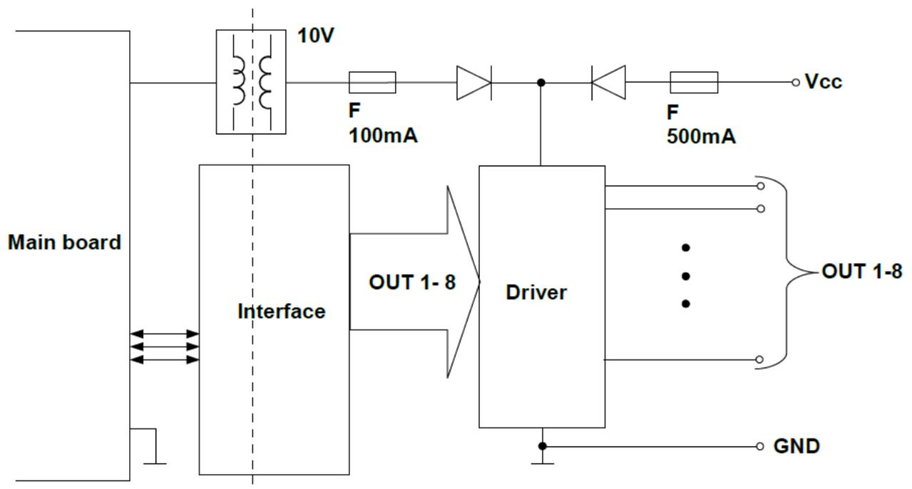
Abb. 8.21 Interne Schaltung des SSR-Ausgangsmoduls (8 Ausgänge)
