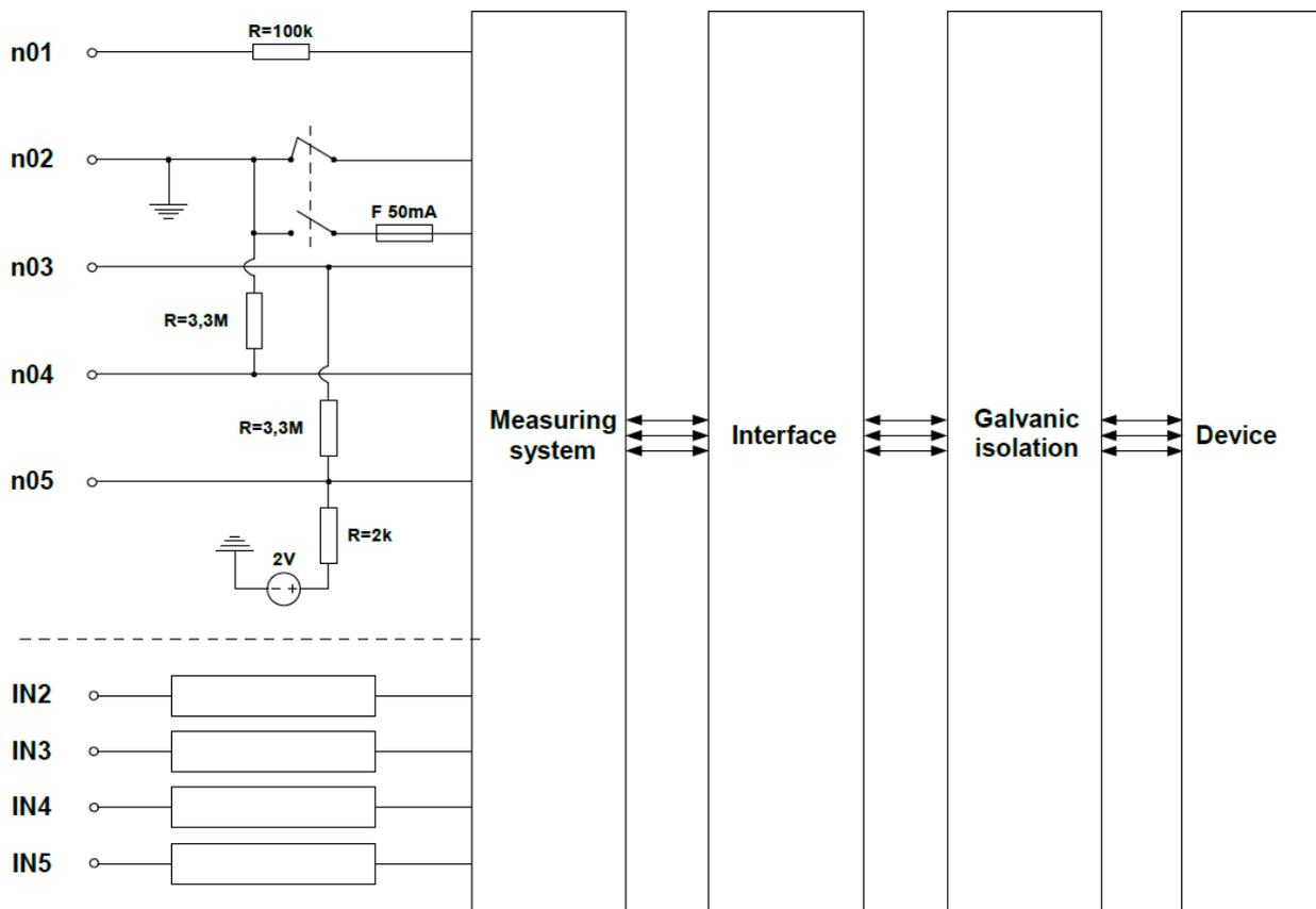
Abb. 8.13 Aufbau des Moduls mit getrennten Universaleingängen
