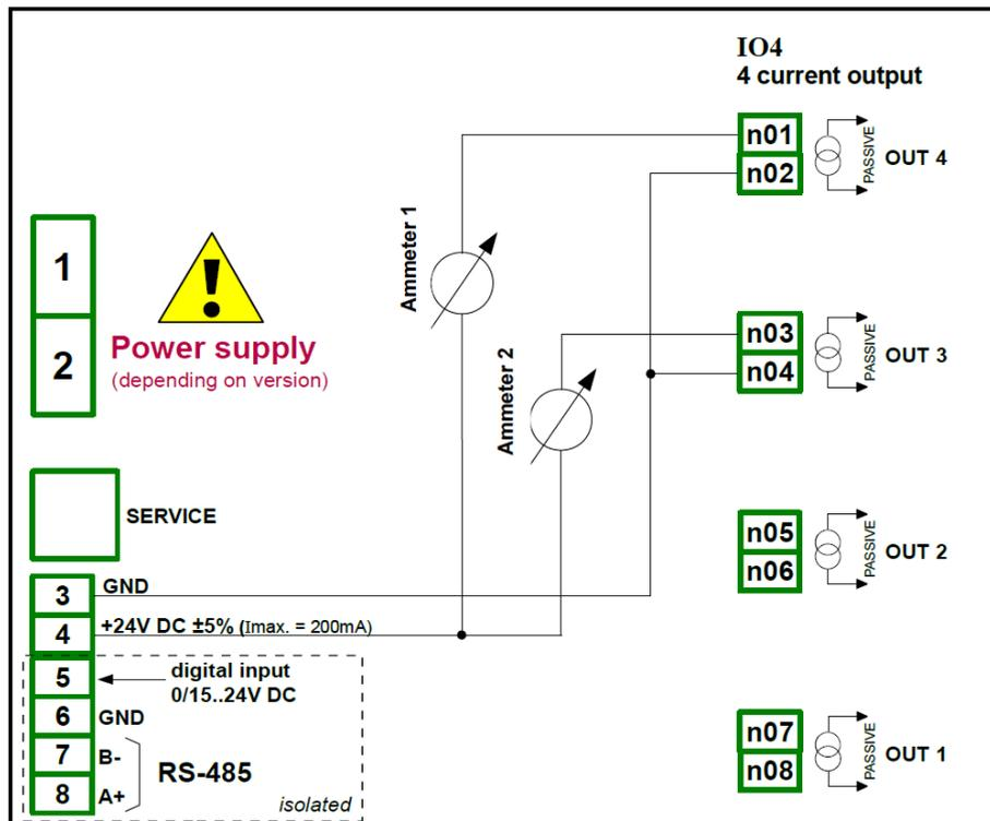
Abb. 8.26 Anschluss der Stromausgänge, ausgehend vom Bezugspotential
