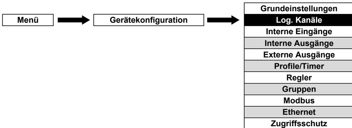
Dieses Untermenü wird für die Konfiguration Logischer Kanäle verwendet. Die Daten (Werte) der hier definierten Kanäle können als Eingangsdaten für Ausgänge, Regler oder anderer logischer Kanäle benutzt und zur gleichzeitigen Visualisierung in eine Gruppe zusammengefasst werden. Detaillierte Informationen zu logischen Kanälen, siehe **Allgemeine Merkmale**.
