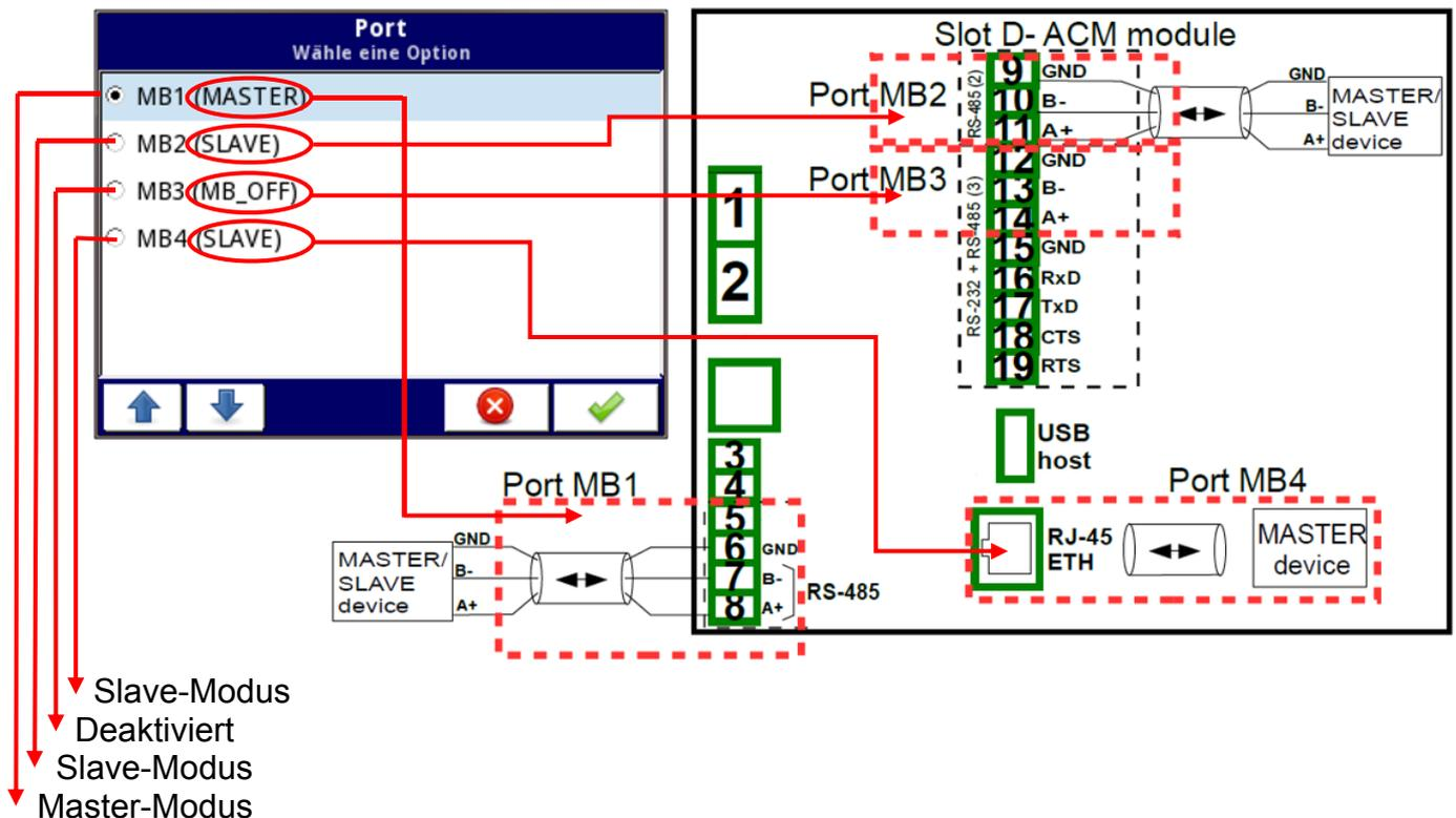
Abb. 7.47 verfügbare Modbus-Schnittstellen
