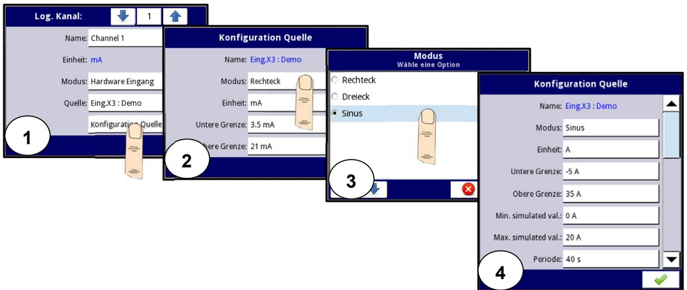
Abb. 7.76 Bsp. für die Konfiguration eines Demo-Eingangs
