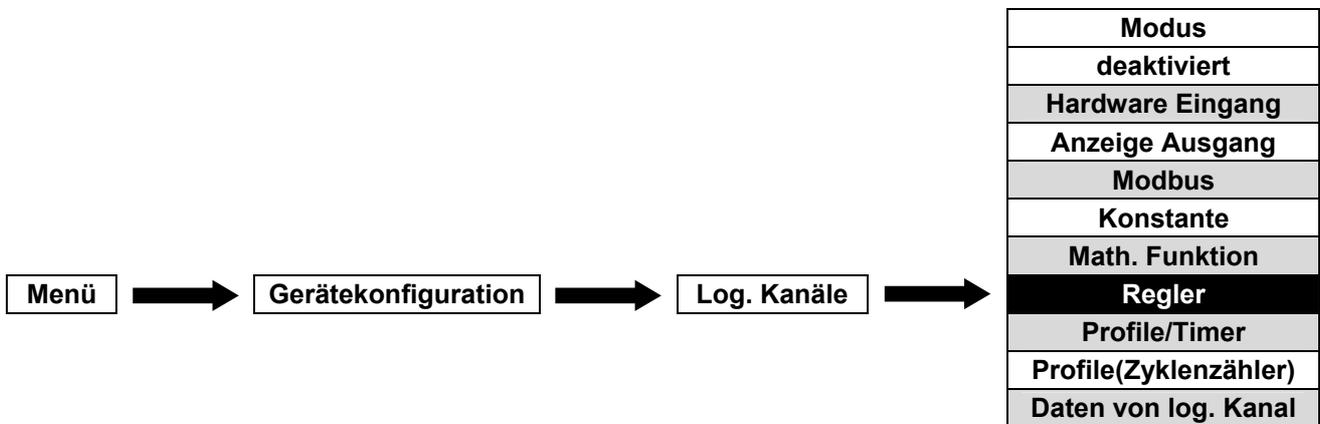
Dieser Modus ermöglicht es, einen Regelkreis zu erstellen und für die Anzeige oder weitere Verarbeitung zu nutzen.
