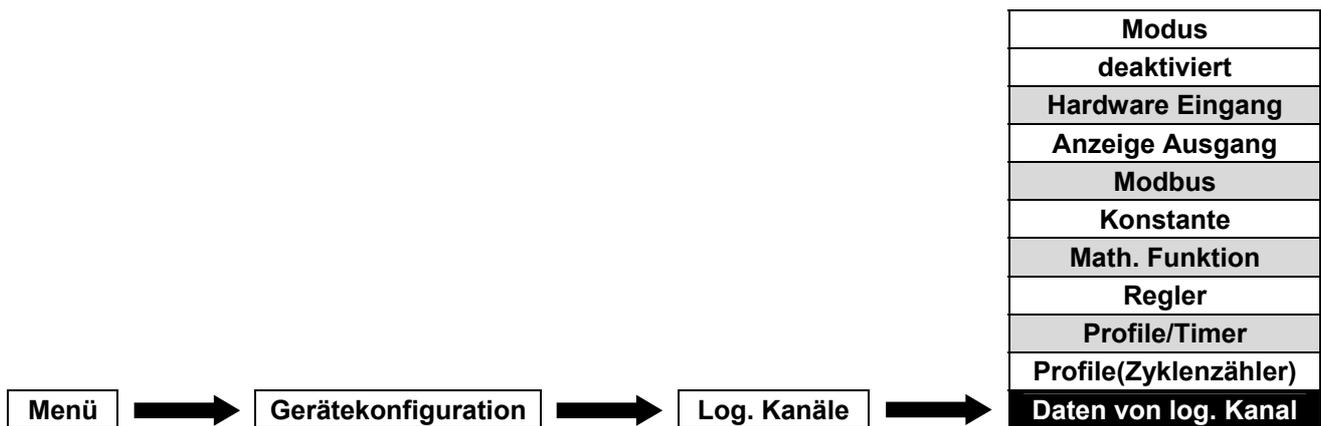
Dieser Modus ermöglicht es, den Wert eines anderen log. Kanals zu kopieren und für die Anzeige oder weitere Verarbeitung zu nutzen. Für Eingangsmodulen mit mehreren Signalen (z.B. FI4/FT4 Momentanwert und Summierung) kann über diesen Modus der zweite Signalwert ermittelt werden.
