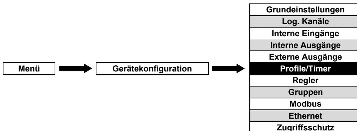
Dieses Menü ermöglicht es, einen benutzerdefinierten Signalverlauf zu erstellen und für die Anzeige oder weitere Verarbeitung zu nutzen.
