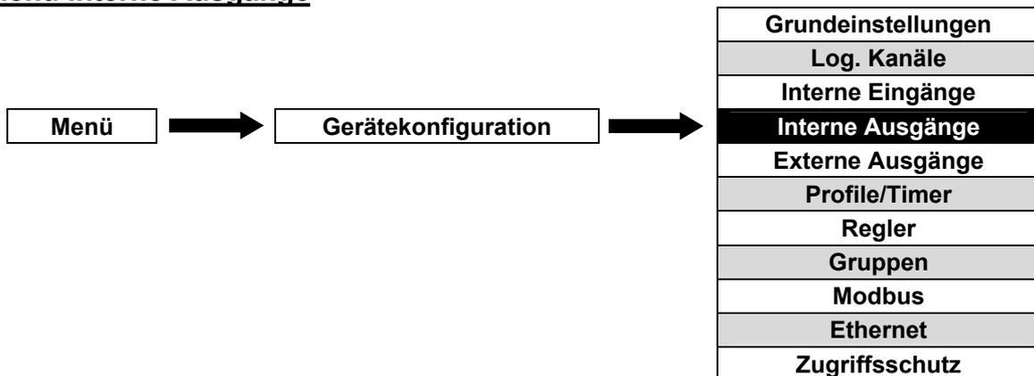
Dieses Menü ist direkt mit den tatsächlich installierten Ausgangsmodulen verknüpft. Die Basisversion des Gerätes enthält bereits folgende Ausgänge:
