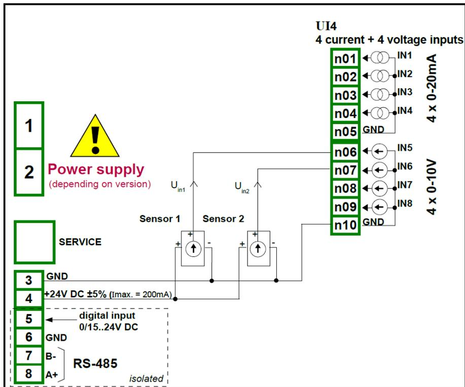
Abb. 8.6 Anschluss von 3-Leiter-Messumformern(Spannungsmessung)
