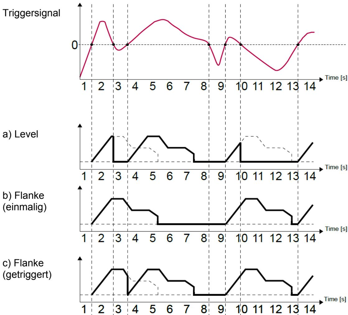
Abb. 7.102 Einfluss des Triggermodus auf den Profilverlauf
