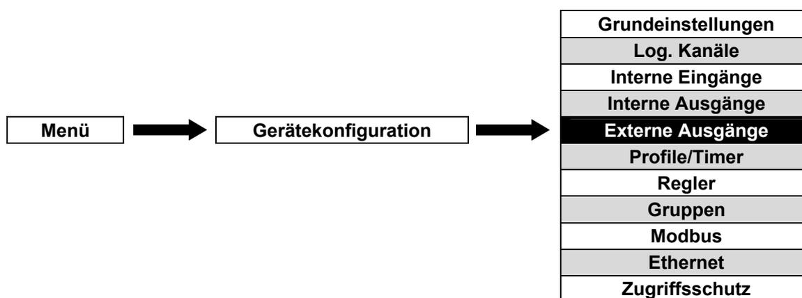
Über dieses Menü wird definiert welche Daten vom Master-Gerät über das Protokoll Modbus RTU an ein Slave-Gerät gesendet werden. Die Konfiguration der Schnittstelle(Baudrate, Slave-Parameter, Adresse, Register usw.) erfolgt über das Menü **Modbus**(siehe 7.15.3).
