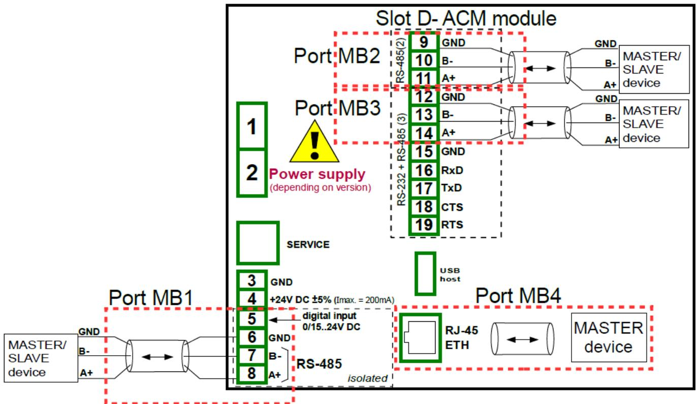
Abb. 7.120 serielle Schnittstellen des Geräts
