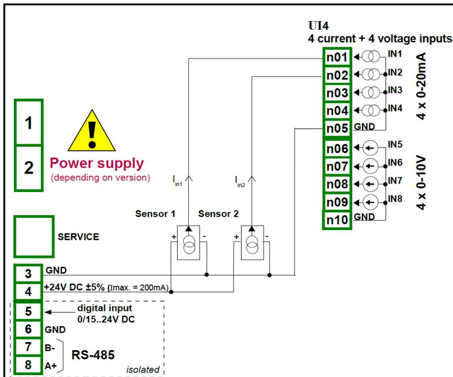
Abb. 8.5 Anschluss von 3-Leiter-Messumformern (Strommessung)
