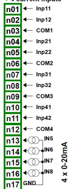
Abb. 4.12 Flowmeter-Eingangsmodule
