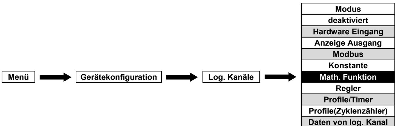
Dieser Modus ermöglicht es, das Ergebnis einer mathematischen/logischen Funktion in einem log. Kanal zu definieren und für die Anzeige oder weitere Verarbeitung zu nutzen.
