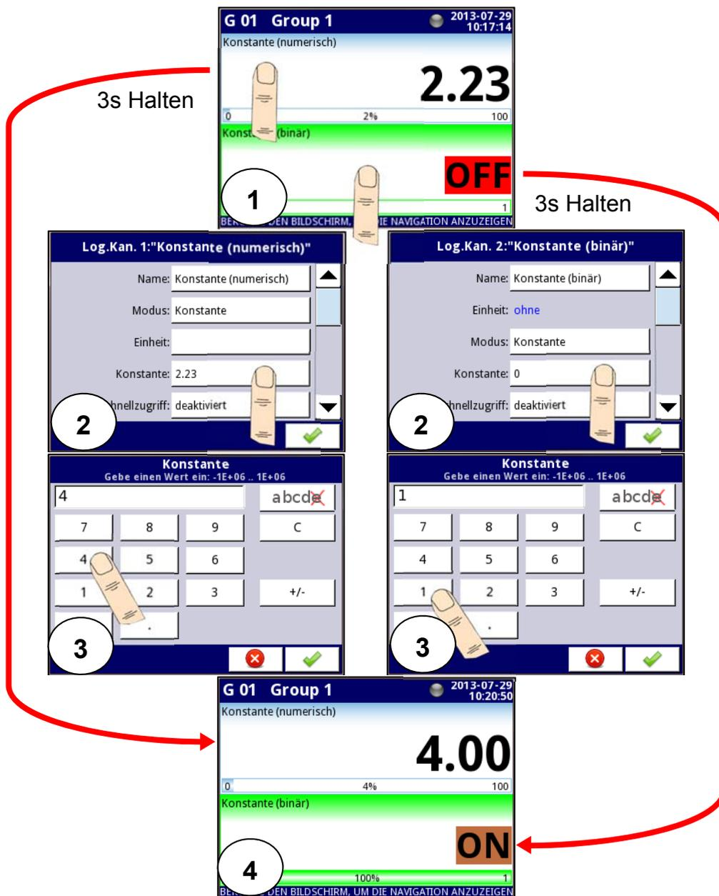
Abb. 7.50 log. Kanäle im Modus Konstante mit deaktiviertem Schnellzugriff
