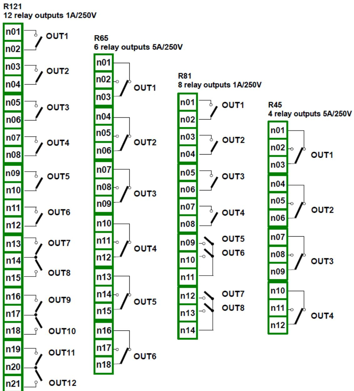
Abb. 8.23 Relais-Ausgangsmodule
