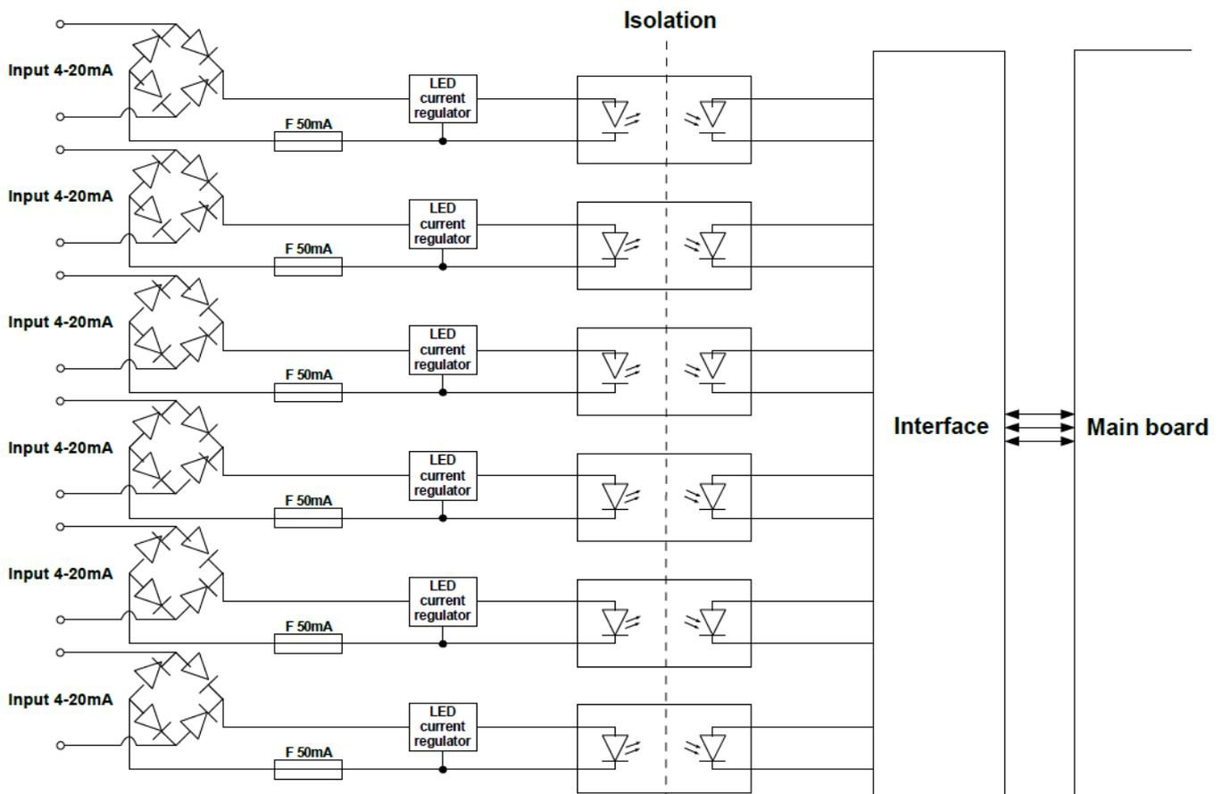
Abb. 8.8 Aufbau des Moduls mit getrennten Stromeingängen
