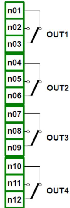
Abb. 4.19 Relais-Ausgangsmodule
