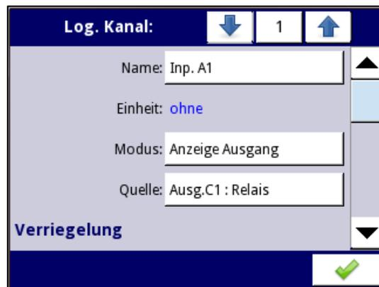
Abb. 7.44 log. Kanal im Modus Anzeige Ausgang
