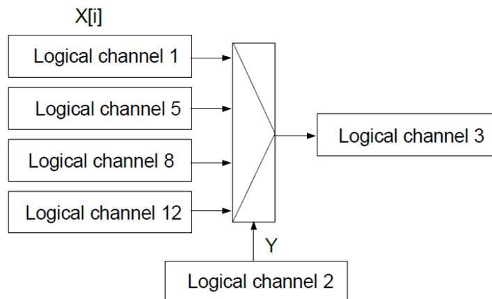
Abb. 7.71 Blockdiagramm der Funktion  $X[i]$  selected by Y
