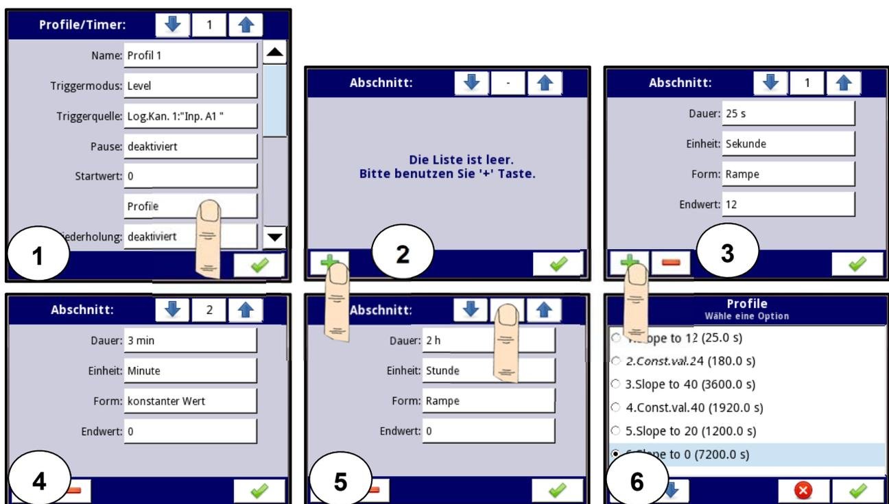
Abb. 7.99 Konfiguration eines Profils
