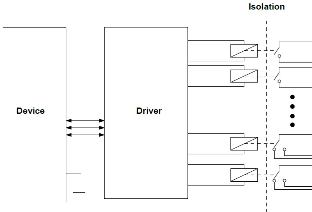
Abb. 8.24 Interne Schaltung der Relais-Ausgangsmodule
