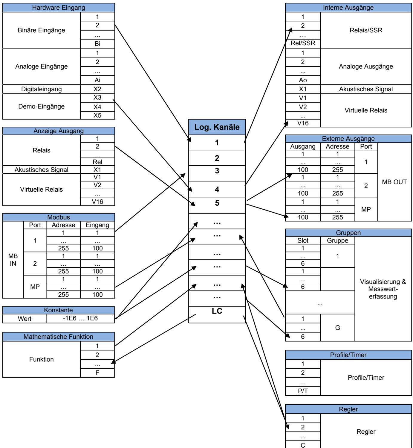
Abb. 5.1 Möglichkeiten der Verknüpfung von logischen Kanäle
