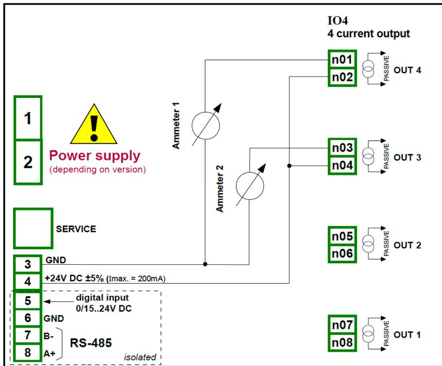
Abb. 8.27 Anschluss der Stromausgänge, ausgehend von der Versorgung
