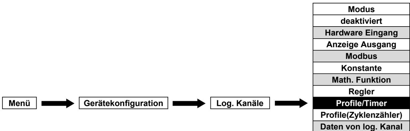
Dieser Modus ermöglicht es, einen benutzerdefinierten Signalverlauf zu erstellen und für die Anzeige oder weitere Verarbeitung zu nutzen.
