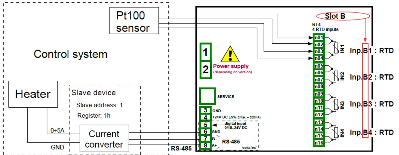
Abb. 7.110 Anschluss von Konverter und Widerstandsthermometer
