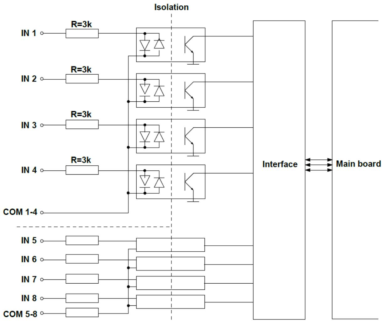
Abb. 8.15 Interne Schaltung der optokoppler-getrennten Binär-Eingangsmodule
