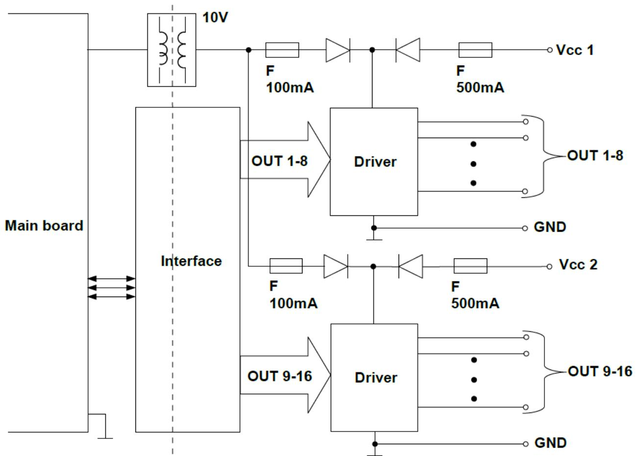
Abb. 8.22 Interne Schaltung des SSR-Ausgangsmoduls (16 Ausgänge)
