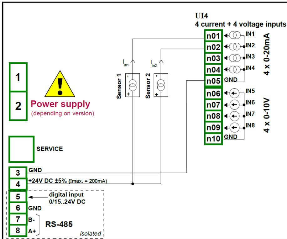
Abb. 8.4 Anschluss von 2-Leiter-Messumformern (Strommessung)
