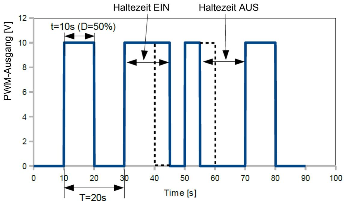
Abb. 7.87 PWM-Ausgangssignal
